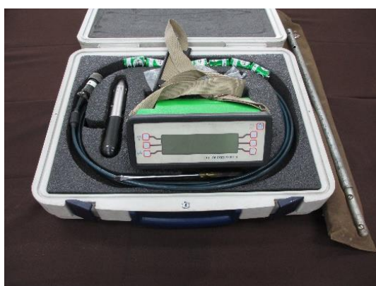
ค) วัดความเร็วของน้ำด้วย current meter
