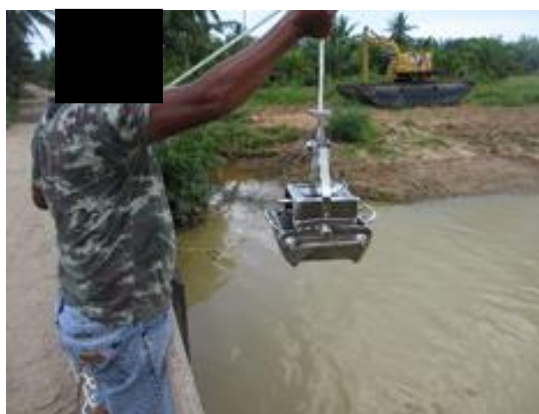
ฉ) เก็บวัสดุท้องน้ำด้วย Van Veen grab sampler
